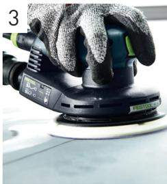
Einen weiteren Vorteil bietet die hoch temperaturbeständige Klette, die auch bei Heavy-Duty Anwendungen (Abb. 3), z.B. Abschleifen von Altlacken, Schleifen von Spachtel mit hoher Temperaturentwicklung bestens geeignet ist.
