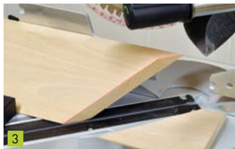
3 Die Anzeigepräzision des Doppellinien-Lasers überrascht auch bei diesem Anwendungsbereich. Beide Laser können sogar noch bei Bedarf fein nachjustiert werden.
