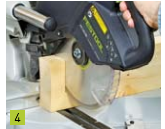
4 ... Balken bis zu einem Querschnitt von 120 x 60 mm möglich.
