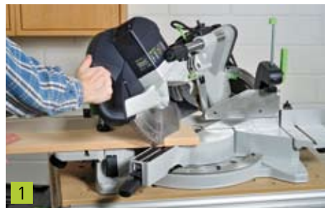
1 Bei einem Schifterschnitt wird das Sägeblatt sowohl horizontal, als auch vertikal geschwenkt. Diese Schnitte werden häufig bei großen Kranz- und Sockelprofileisten eingesetzt.
