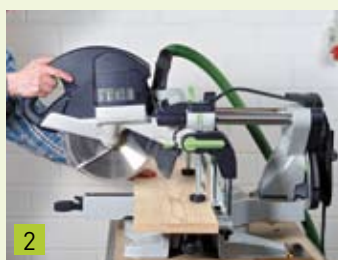
2 Säge einschalten und Sägeblatt ins Werkstück eintauchen
