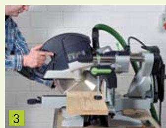
3 In dieser Position Sägeblatt auf den Führungsstangen zurück schieben
