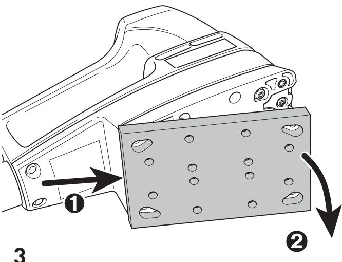
La mise en place d'un nouveau patin de ponçage s'effectue dans la suite inverse des opérations d'enlèvement.
