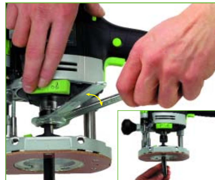
Le changement de fraise est pratique, rapide et sûr grâce au dispositif à cliquet.
